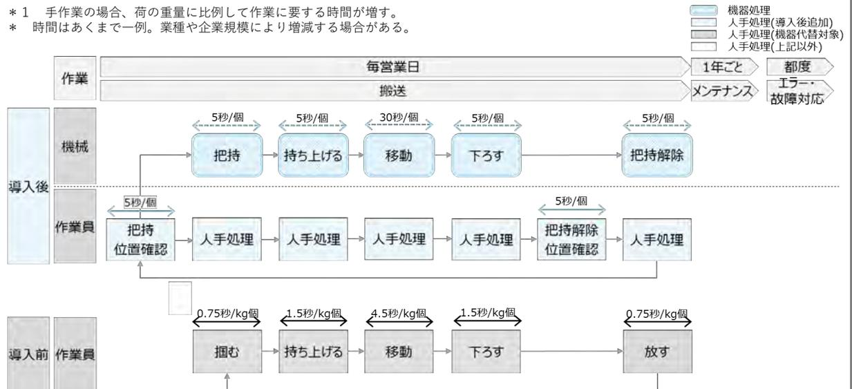
\* 手作業の場合、荷の重量に比例して作業に要する時間が増す。
